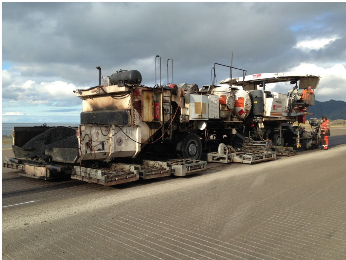
Bilde 11.2 Remixer i produksjon på rullebane/ flyplass
