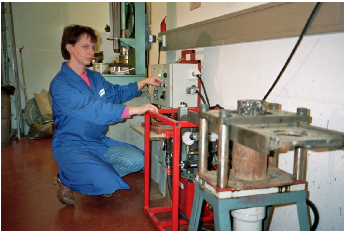
Figur 7.8 Tillaging av prøver med statisk presse
