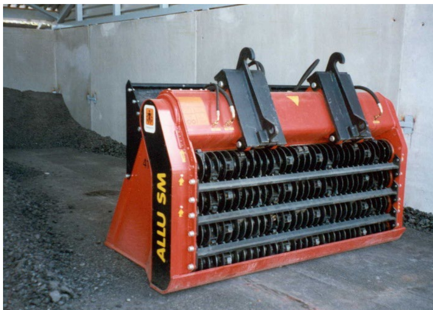
Bilde 6.4 Granuleringskuffe sett fra undersiden
