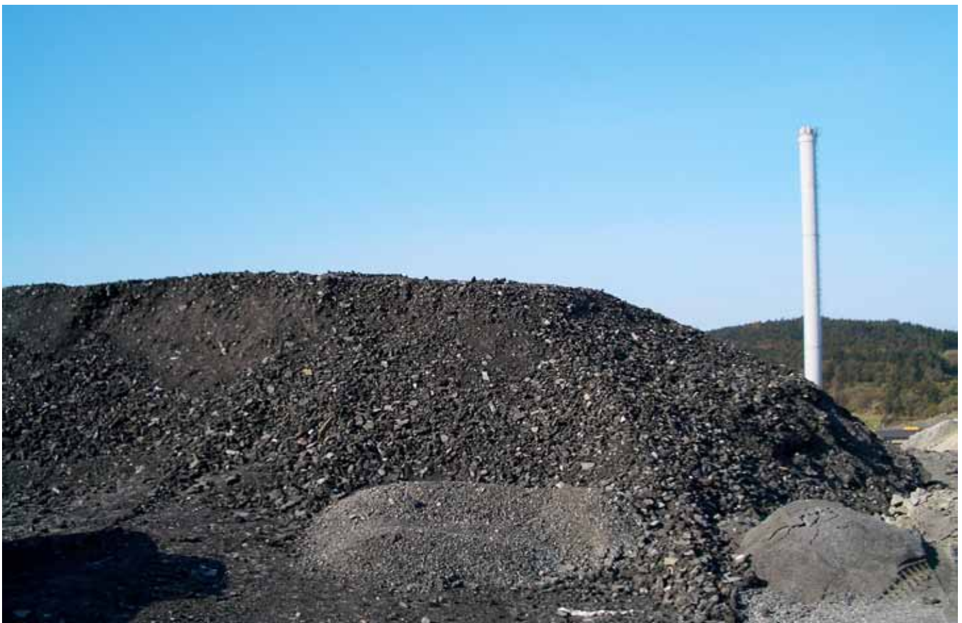
Asfaltgranulat er et ypperlig materiale til bygging og vedlikehold av skogsbilveier. Foto av lagerhaug Fana Stein AS.
